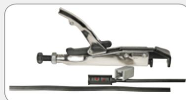
Flachkabel (2 x 1,5 mm<sup>2</sup>) in den P&R Verbinder einlegen.
