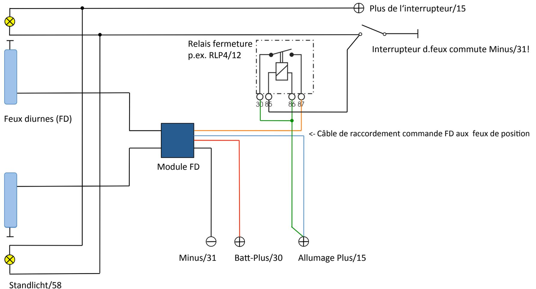
\* Si l'allumage est activé, les feux diurnes s'éclairent. Si les feux de position sont activés, le relais se lève, le câble de commande du module FD reçoit Plus et les feux diurnes s'éteignent.
