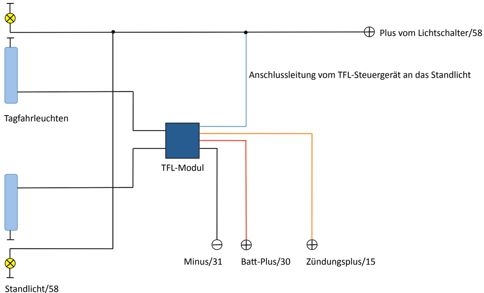
\* Wird die Zündung eingeschaltet, leuchten die Tagfahrleuchten. Wird das Standlicht eingeschaltet, löschen die Tagfahrleuchten wieder.
