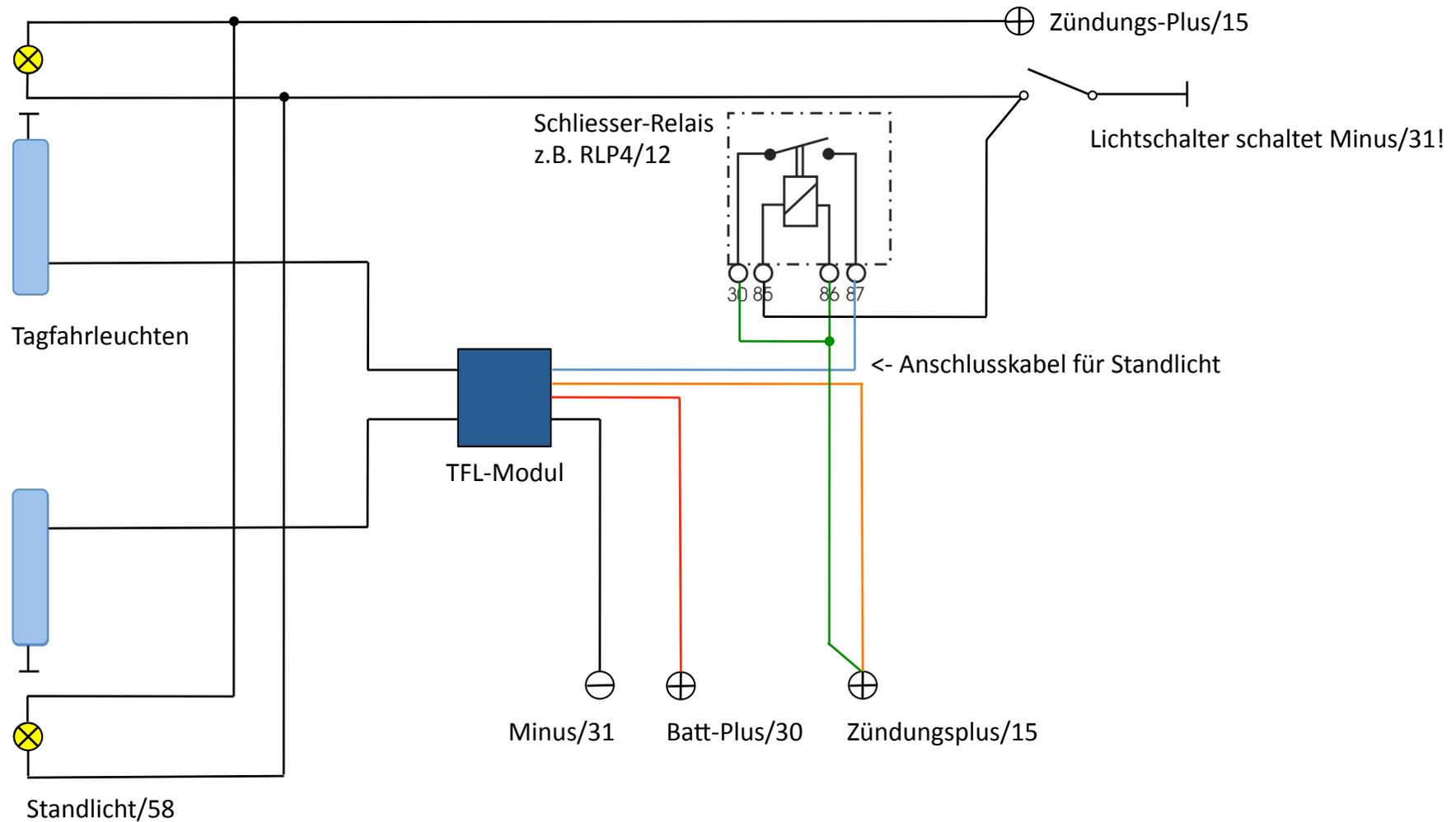
\* Wird die Zündung eingeschaltet, leuchten die Tagfahrleuchten. Wird das Standlicht eingeschaltet, zieht das Relais an, das Steuerungskabel des TFL-Moduls erhält Plus, und die Tagfahrleuchten löschen wieder.
