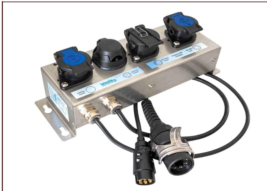
Komplette Wandlereinheit für Landwirtschafts-Traktoren 12V auf 24V für Beleuchtung und ABS. Am Eingang sind Stecker und am Ausgang sind Dosen montiert. Parkdosen nehmen bei Nichtgebrauch die freien Stecker auf. Die Einheit ist in einem Edelstahl-Metallträger montiert. Die verwendeten Wandler sind ABS 12-24 und ASV 12-24-6H.
