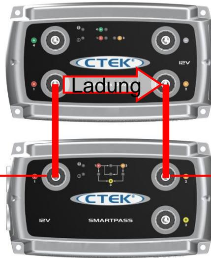
SmartPass trennt die direkte Verbindung von der Lichtmaschine. Das D250S Dual beendet die Ladung mit reduzierter Spannung und reduziertem Strom
