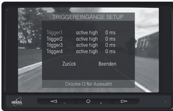
Im Menü «Triggereingänge Setup» werden die Triggereingänge auf die angeschlossenen Fahrzeugsignale angepasst. Dazu stehen folgende Einstellmöglichkeiten zur Verfügung:
