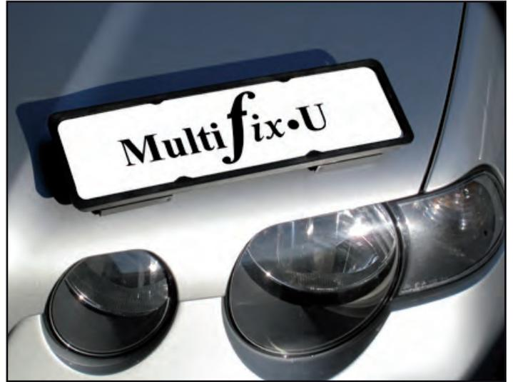
Befestigung egal auf welchen metallischen Teilen des Autos durch stark haftende bewegliche mit Gummi gepolsterte Magnete (verhindert das Zerkratzen der Karosserie).
