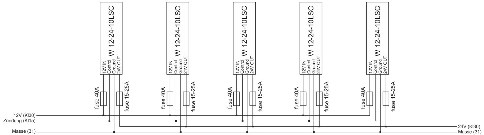
Es muss ein ausreichend großer Kabelquerschnitt am Eingang sowie am Ausgang verwendet werden am Eingang können Ströme von bis zu 120A (bei 12V) bzw. 144A (bei 10V) auftreten, wenn der Ausgang mit 50A belastet wird.
