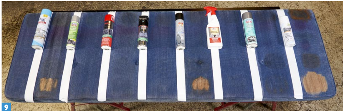
9 Die Endergebnisse stehen in engem Zusammenhang mit den unterschiedlichen Anwendungshinweisen der einzelnen Mittel. Das Feld ganz rechts dient als Referenz für die Verschmutzung vor der Reinigung.
