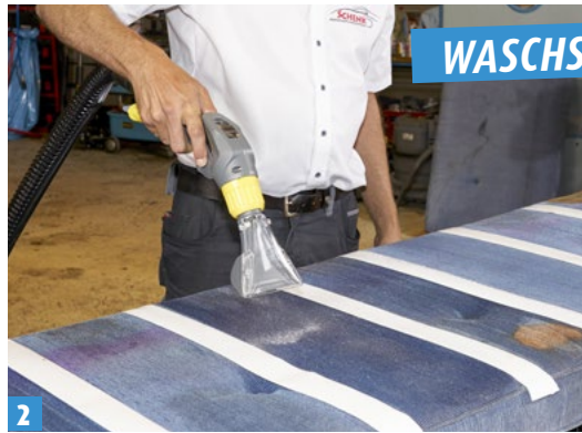
2 Anschließend werden die verunreinigten Polster zunächst mit der Reinigungslösung eingesprüht.
