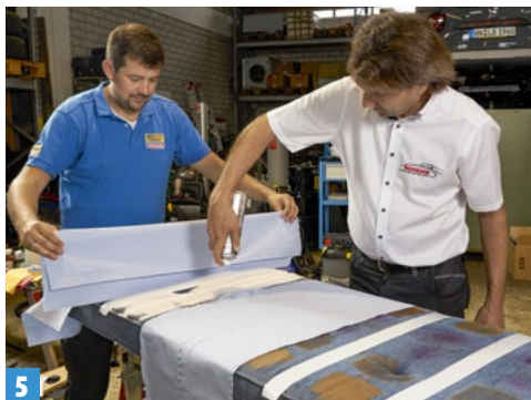
5 Benachbarte Bahnen werden abgedeckt, damit sie beim Aufsprühen der Reiniger nichts abbekommen.
