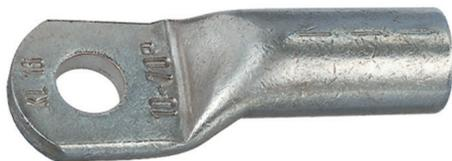
Presskabelschuhe nach DIN 46235 weisen Pressmarkierungen auf, haben andere Abmessungen als Rohrkabelschuhe und werden vor allem in der Elektro-Industrie eingesetzt
