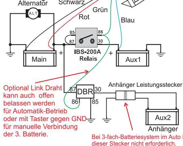
Optional Link Draht kann auch offen belassen werden für Automatik-Betrieb oder mit Taster gegen GND für manuelle Verbindung der 3. Batterie.
