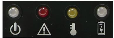
\*\* Wenn der Wechselrichter ausgeschaltet ist, leuchten die ersten drei LEDs nicht, sondern nur die vierte.
