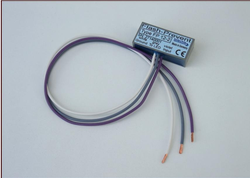
Flash-Prevent verhindert effektiv das unzulässige Aufblitzen von LED Lampen durch die fahrzeugseitige Impuls-Kaltabfrage („harter“, kurzer Impuls ca. 10ms). Ein LED-Ausfall wird erkannt. Achtung! Flash Prevent ersetzt nicht LED-ADAPT! Bitte Details anfragen.
