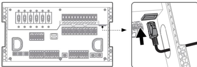
7. Verwenden Sie einen Kreuzschlitzschraubendreher, um die AC- und DC-Eingangsleitungen mit Schrauben an den entsprechenden Eingangsklemmen zu befestigen (AC: M4\*10 Schrauben; DC: M5\*10 Schrauben).
