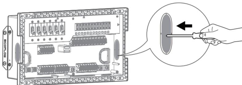
5. Schließen Sie die AC-Leitungen von der linken Seite und die DC-Leitungen von der rechten Seite an. Es wird empfohlen, die Kabel durch die entsprechenden Ein- und Ausgänge zu führen (z. B. sollten die AC-Eingangskabel immer durch den AC-Eingang und die AC-Ausgangskabel durch den AC-Ausgang geführt werden). Dadurch werden mögliche Probleme bei der Verkabelung und der elektrischen Sicherheit vermieden.
