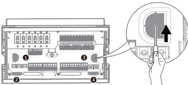
4. Schließen Sie die AC-Leitungen von der linken Seite und die DC-Leitungen von der rechten Seite an. Es wird empfohlen, die Kabel durch die entsprechenden Ein- und Ausgänge zu führen (z. B. sollten die AC-Eingangskabel immer durch den AC-Eingang und die AC-Ausgangskabel durch den AC-Ausgang geführt werden). Dadurch werden mögliche Probleme bei der Verkabelung und der elektrischen Sicherheit vermieden.
