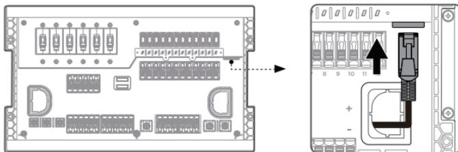
6. Verwenden Sie einen Kreuzschlitzschraubendreher, um die AC- und DC-Eingangsleitungen mit Schrauben an den entsprechenden Eingangsklemmen zu befestigen (AC: M4\*10 Schrauben; DC: M5\*10 Schrauben).
