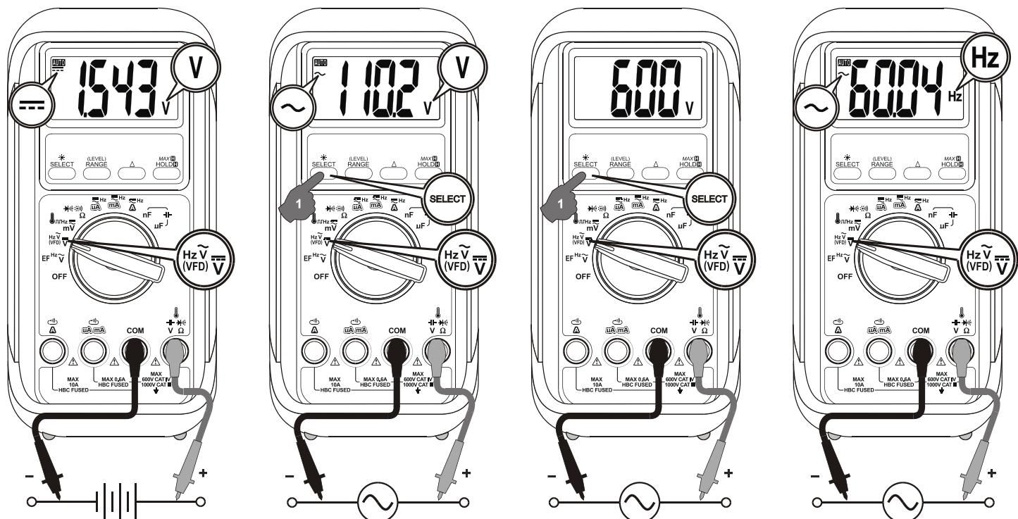
**Hinweis:** VFD-ACV und VFD-Hz sind mit einem digitalen Tiefpassfilter (DSP) ausgestattet und können VFD-Signale (Variable Frequency Drives) für grundlegende V- und Hz-Messwerte verarbeiten. Es verbessert auch die ACV- und Hz-Lesestabilität, wenn es in den meisten elektrisch verrauschten Umgebungen verwendet wird.
