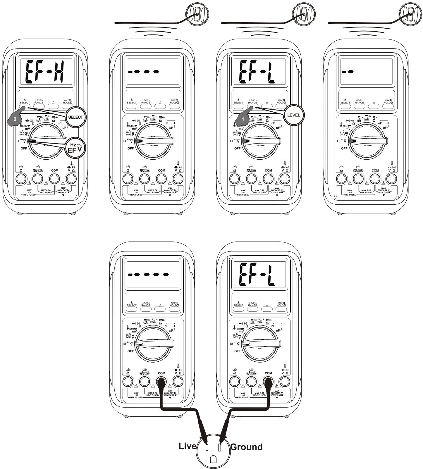
• **Berührungslose EF-Erkennung (NCV):** Eine Antenne befindet sich in der Nähe des oberen Endes in der Mitte des Messgeräts, die erkennt das elektrische Wechselfeld, das unter Spannung stehende Leiter umgibt. Es ist ideal zum Verfolgen von stromführenden Kabelverbindungen, zum Lokalisieren von Kabelbrüchen und zum Unterscheiden zwischen stromführenden und geerdeten Verbindungen.
