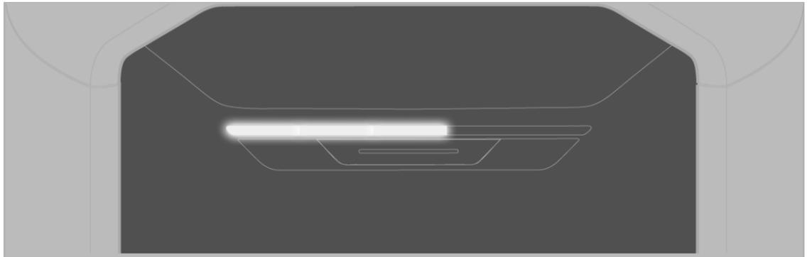
Wenn ein Teil der Status LED blinkt, bedeutet dies, dass die Batterie geladen wird.
