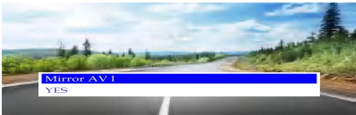
Drücken Sie die MENU-Taste, um in das Mirror AVI-Menü zu gelangen. Wählen Sie „JA“, um das Mirror AVI-System über die "▲ / ▼"-Taste im Bedienfeld zu aktivieren. Der Standardparameter ist „AUS“.
