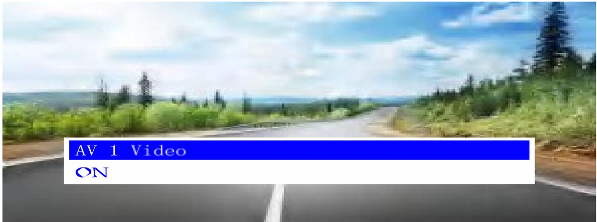
Drücken Sie die MENU-Taste, um in das AVI Video-Menü zu gelangen. Wählen Sie „EIN“, um den AVI-Videomodus über die "▲ / ▼" Taste im Bedienfeld zu aktivieren. Der Standardparameter ist „AUS“.
