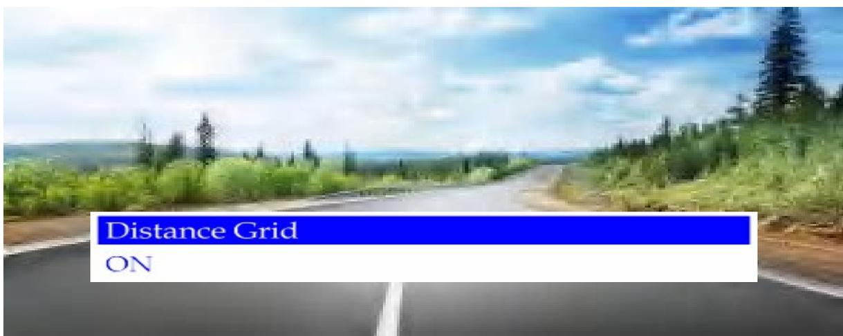
Drücken Sie die MENU-Taste, um in das Distance Grid-Menü zu gelangen. Wählen Sie „EIN“, um die Funktion über die "▲ / ▼" Taste im Bedienfeld zu aktivieren. Der Standardparameter ist „AUS“.
