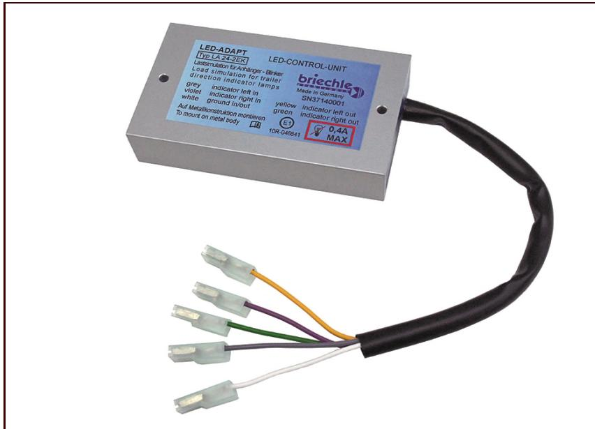
24 Volt Widerstands - Ersatzlast zur Anpassung von Leuchtdioden-Anhängerlampen an Fahrzeuge mit Glühlampenüberwachung. Der Ausfall einer Blinker-LED-Einheit wird erkannt und die Ersatzlast abgeschaltet. LED-ADAPT muss auf eine Metallfläche montiert werden. \*\*\*ACHTUNG\*\*\* Der Anschluss von Glühlampen am Ausgang ist unzulässig. Der Kurzschlusschutz schaltet unter Umständen erst nach mehreren Minuten ab!
