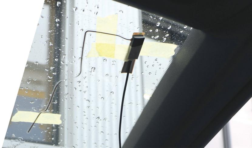
Scheibenklebeantenne provisorisch mit Malerklebeband befestigt
