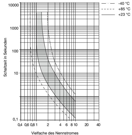
Die Zeit/Strom-Kennlinien sind abhängig von den Umgebungstemperaturen. Um eine vorzeitige oder späte Abschaltung zu vermeiden, muss der Schutzschalterennstrom mit einem Temperaturfaktor multipliziert werden (siehe auch Kapitel Technische Informationen).
