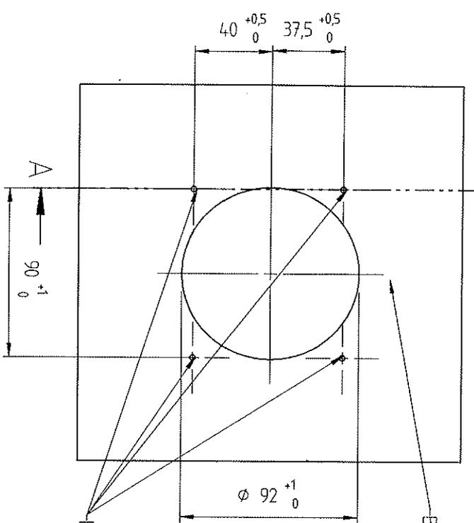
Bohrungsdurchmesser abhängig von Schraubentype.
