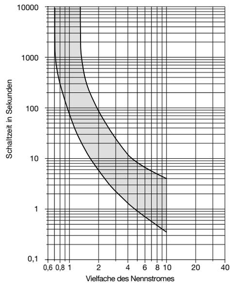
Die Zeit/Strom-Kennlinien sind abhängig von den Umgebungstemperaturen. Um eine vorzeitige oder späte Abschaltung zu vermeiden, muss der Schutzschalterennennstrom mit einem Temperaturfaktor multipliziert werden (siehe auch Kapitel Technische Informationen).
